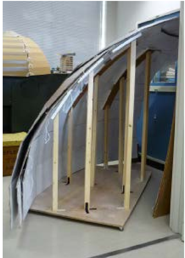
図13 ドームを収納し、まとめて移動できるように「収納ラック」も製作した。
