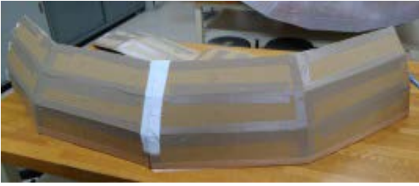
図7 図3の上部、中部、下部ごとに各パーツをガムテープでつなげていった。
