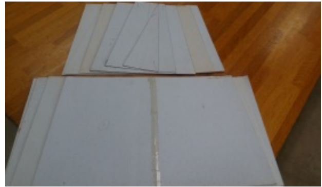
図4 厚紙を用いて型紙を作製し、同じサイズのパーツを多数正確に作れるように工夫した。
